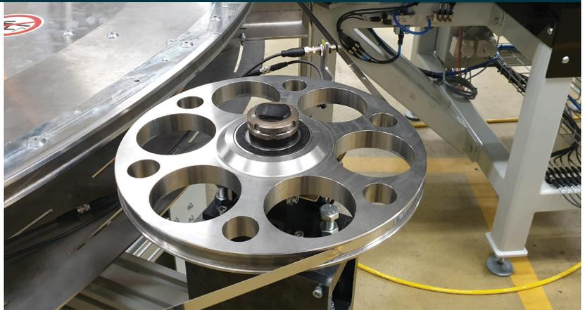
Das Stahlband wird um den Rundschalttisch gelegt (ähnliche Anwendungen existieren) und mit einer kleinen Rolle gespannt. Der Großteil des Stahlbandes steht in Kontakt mit dem Drehtisch.
